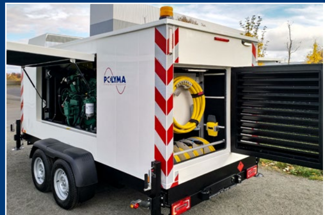
Ein großer Teil Zubehör wird gleich in den Aggregaten gelagert: z. B. Lastkabel und das Zubehör für die Rücksynchronisierung
